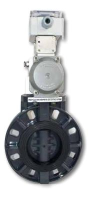
Die MEFCO Absperrklappen sind für die kostengünstige direkte Antriebs-montage nach ISO 5211 vorbereitet. Das Drehmoment der Antriebe wird im Standard mit einem Sicherheitsfaktor von 1,5 ausgelegt. Bei besonderen Betriebsbedingungen kann ein anderer Sicherheitsfaktor gewählt werden, um die Betriebssicherheit der Anlage zu gewährleisten. Die pneumatischen Antriebe sind in den Versionen (DA), (NC) und (NO) lieferbar. Die Anschläge können montagefreundlich von außen eingestellt werden.
