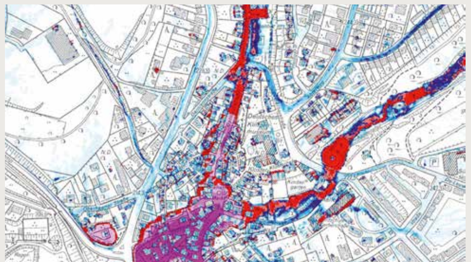
Oberflächensimulation von Starkregen in der Altstadt Gräfrath (Solingen) (Bild: Technische Betriebe Solingen)
