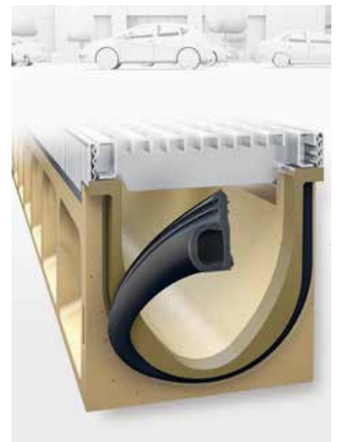
Die neue Entwässerungsrinne ACO DRAIN® Multiline Seal in, gem. DIN EN 1433, ist mit einer werkseitigen integrierten Dichtung ausgestattet. In den Belastungsklassen A15 bis E600 stellt sie sicher, dass vor der Behandlung von Oberflächenwasser zur Einleitung in dezentrale, ortsnahe Regenwasserbewirtschaftungssysteme kein Tropfen verloren geht. (Bild: ACO Tiefbau Vertrieb GmbH)
