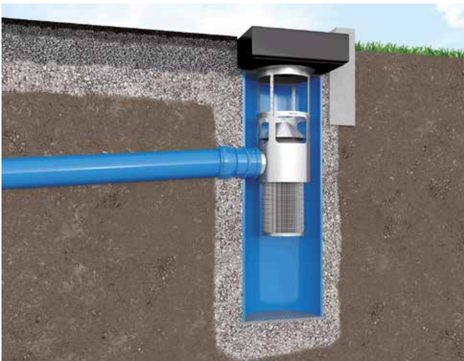
Mit dem für die gezielte dezentrale Reinigung entwickelten Schnellfilter-System Innolet von Funke lassen sich Schadstoffe zuverlässig aus Niederschlagsabfluss von Verkehrsflächen herausfiltern, bevor dieser in Gewässer eingeleitet wird – Schwermetalle, polyzyklische aromatische Kohlenwasserstoffe (PAK) und abfiltrierbare Stoffe (AFS) werden effektiv zurückgehalten. (Bild: Funke Kunststoffe GmbH)
