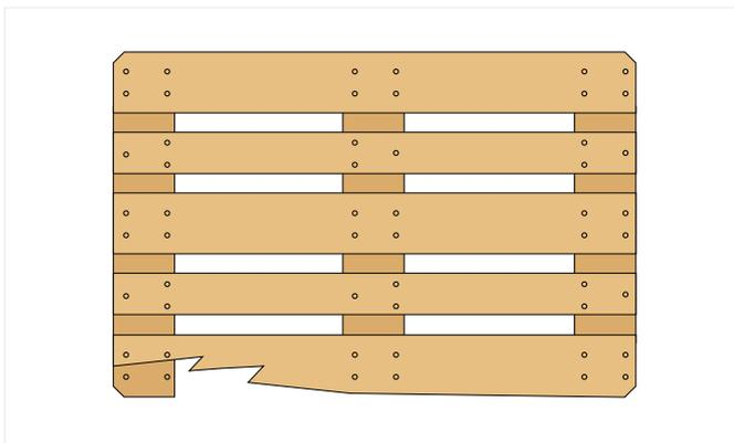
Ein Boden- oder Deckrandbrett ist so abgesplittert, dass mehr als ein Nagel- oder Schraubenschaft sichtbar ist.
