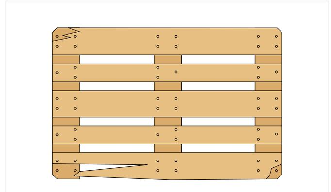
Mehr als zwei Boden- oder Deckrandbretter sind so abgesplittert, daß mehr als ein Nagel- oder Schraubenschaft sichtbar ist.
